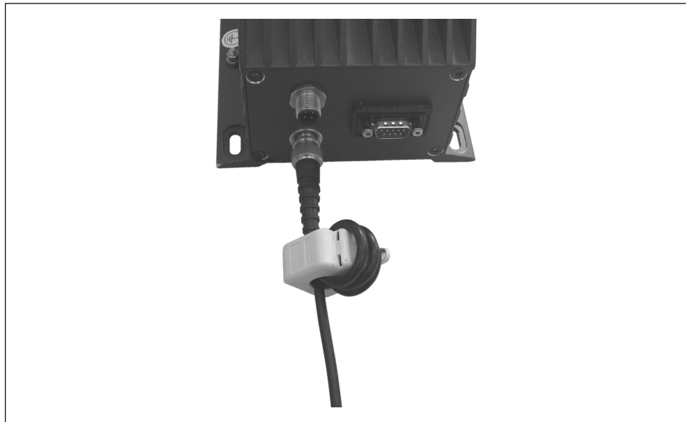
Bild 1 Klapp-Ferrit groß auf der SLG-Seite der Antennenleitung Figure 1 Large split toroidal core on the SLG side of the antenna line
